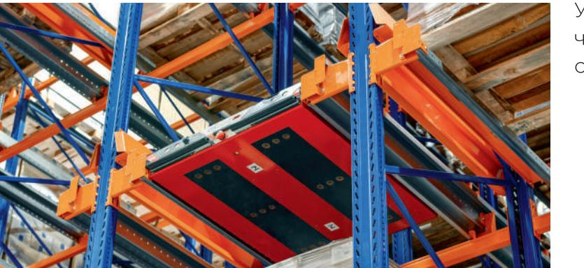
Управление шаттлом осуществляется оператором погрузчика с пульта дистанционного управления или с помощью системы управления складом (WMS).
