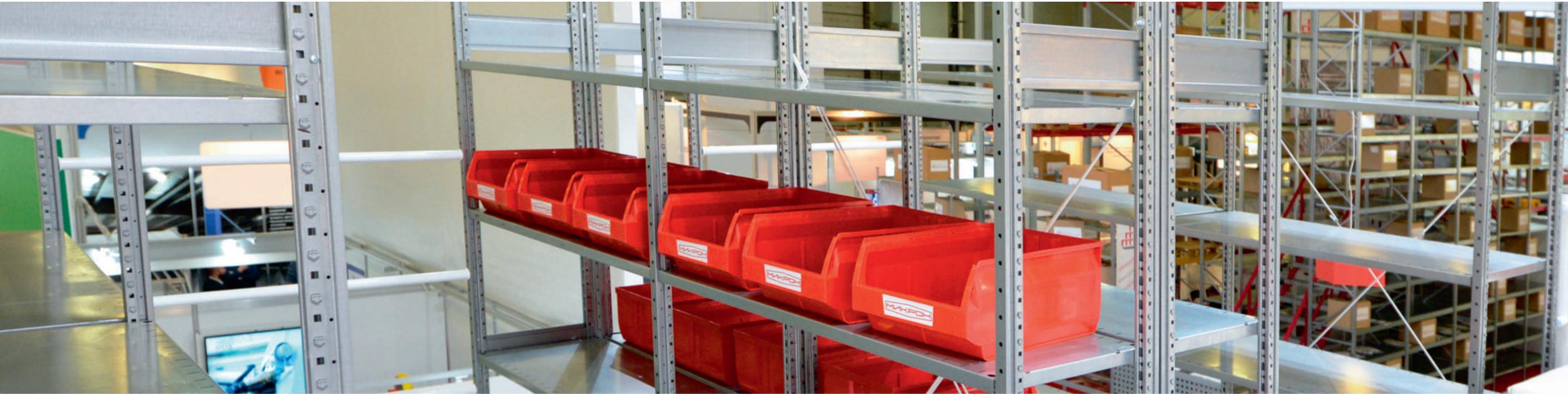
Основным отличием стеллажей серии Modular является отсутствие в конструкции горизонтальных несущих элементов — балок. За счёт применения специальной конструкции полки и узла прямого зацепления с эффектом заклинивания между стойкой и полкой создается необходимая несущая способность. При этом стеллажи остаются достаточно прочными: рама стеллажа выдерживает нагрузку до 6500 кг, полка — до 400 кг.
