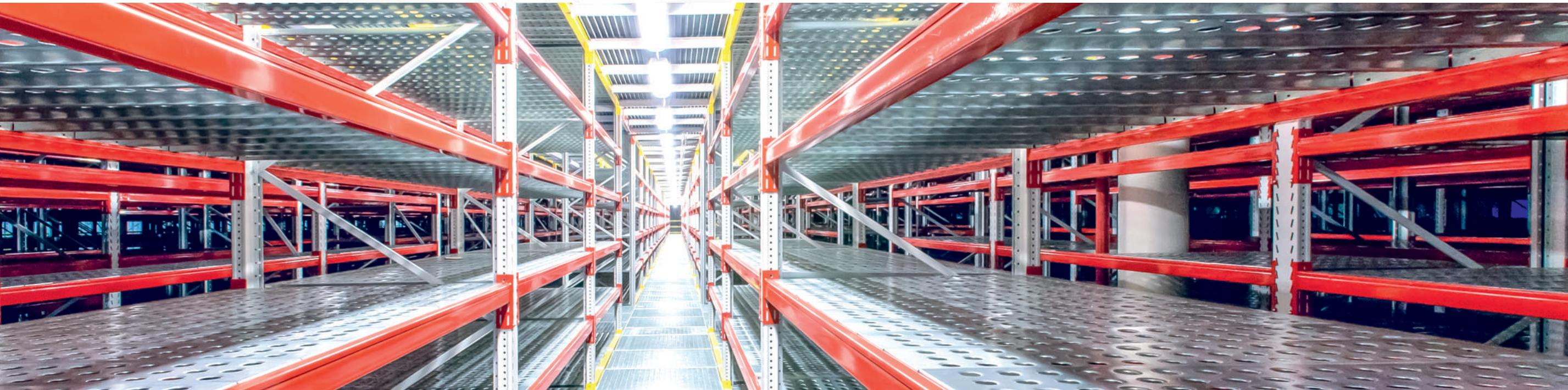
Основными элементами конструкции полочных стеллажей являются вертикальные рамы, горизонтальные балки (для установки полок) и полки. Полочный уровень стеллажа можно переставлять по высоте с шагом 50мм. По конструктивному исполнению металлические полки бывают двух типов: сплошные и с отверстиями для стока воды (пожарозащитные). Кроме металлических полок на стеллажах применяются полки из ДСП.
