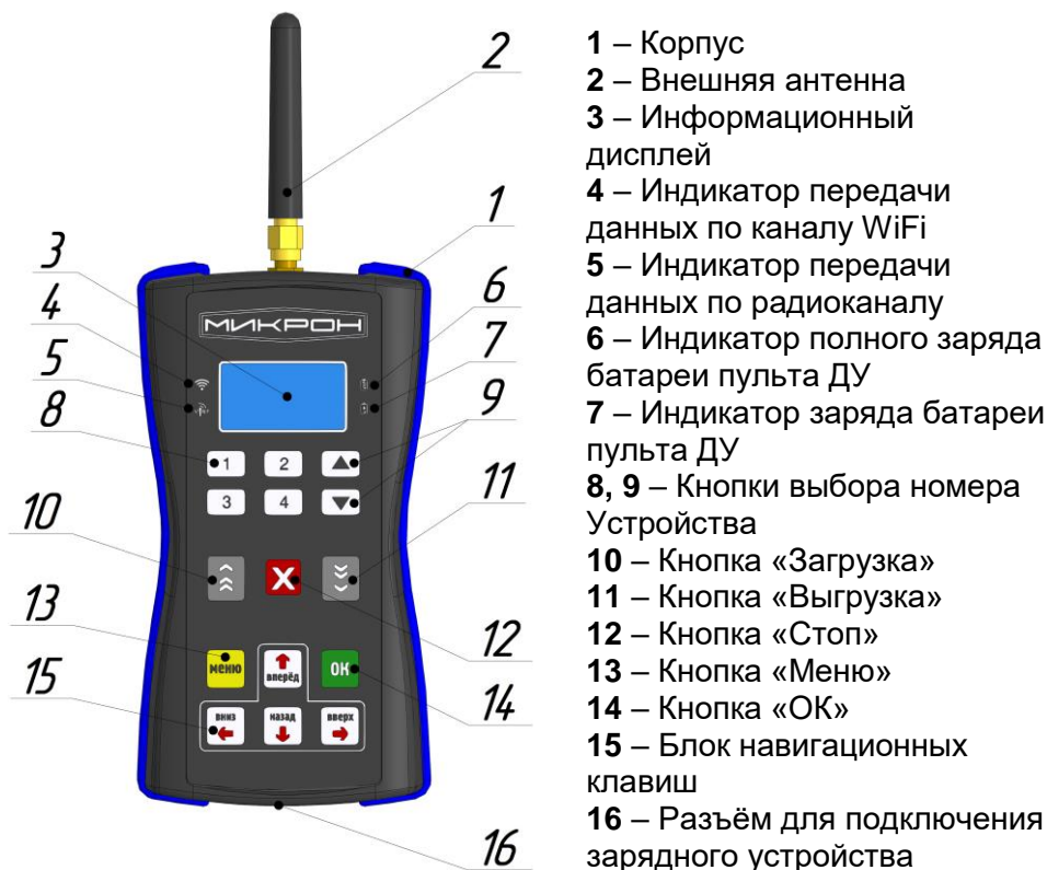
Рисунок 2 – Основные элементы пульта управления Устройства автоматизированной обработки грузов «Микрон»
