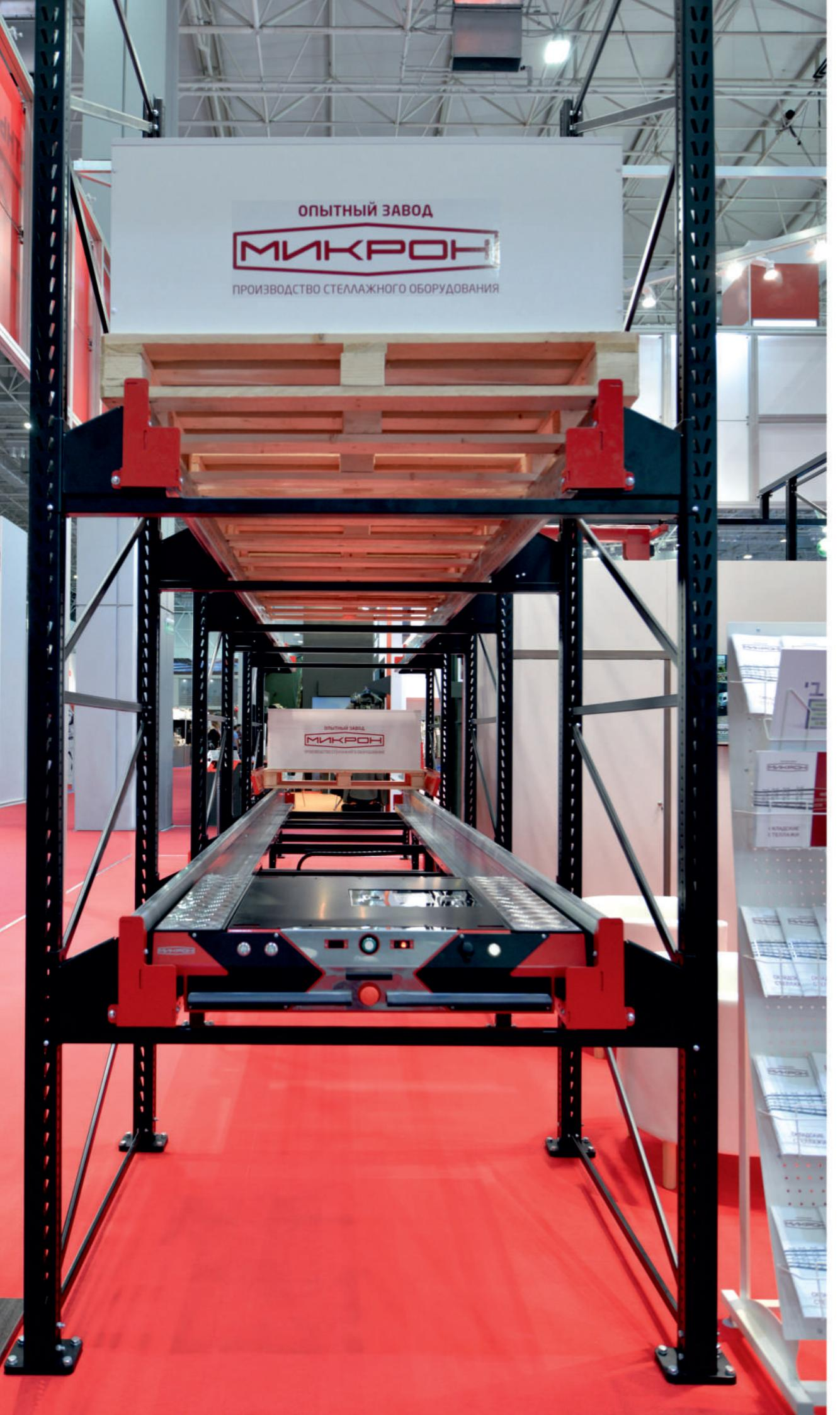
**Загрузка товара начинается с установки шаттла в канал набивного стеллажа.**
